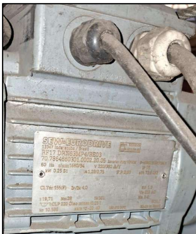
Figura 590: Plaqueta de identificação do motorreductor do trolley
