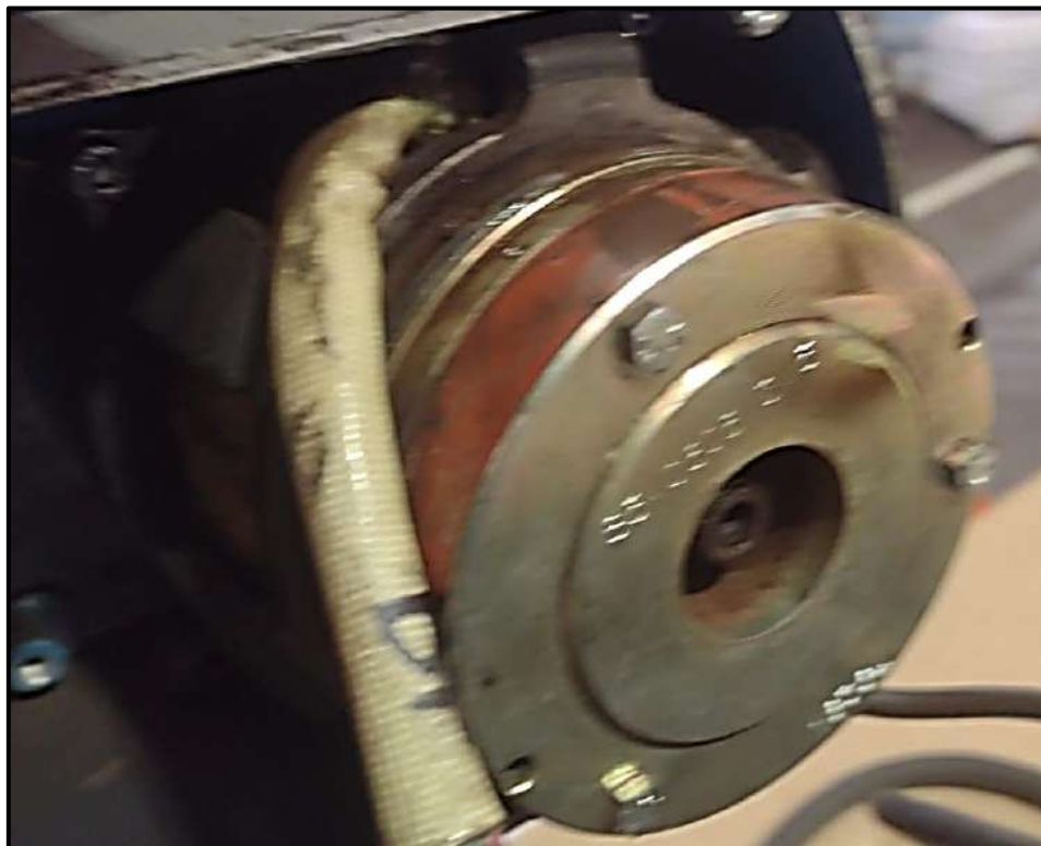
Figura 14: Freio regulado – 0,3 mm
