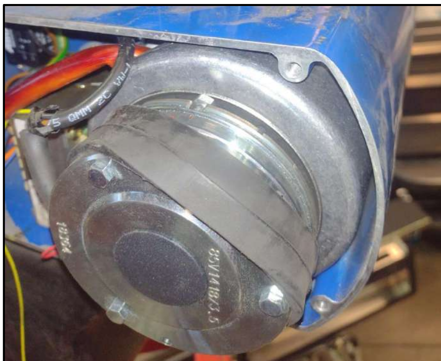
Figura 6: Freio regulado – 0,3 mm
