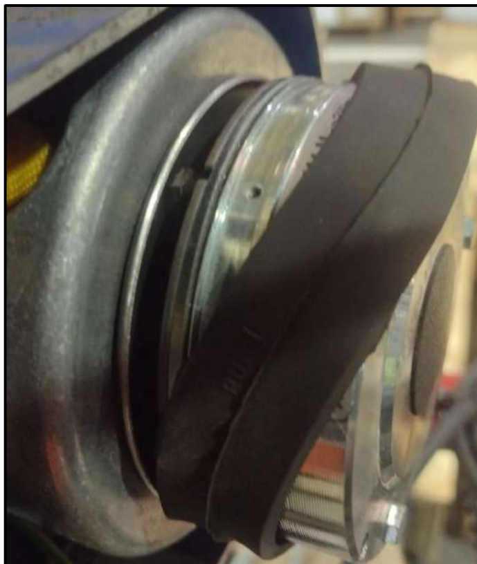
Figura 6: Freio regulado – 0,3 mm
