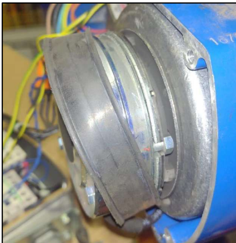
Figura 13: Freio regulado – 0,5 mm
