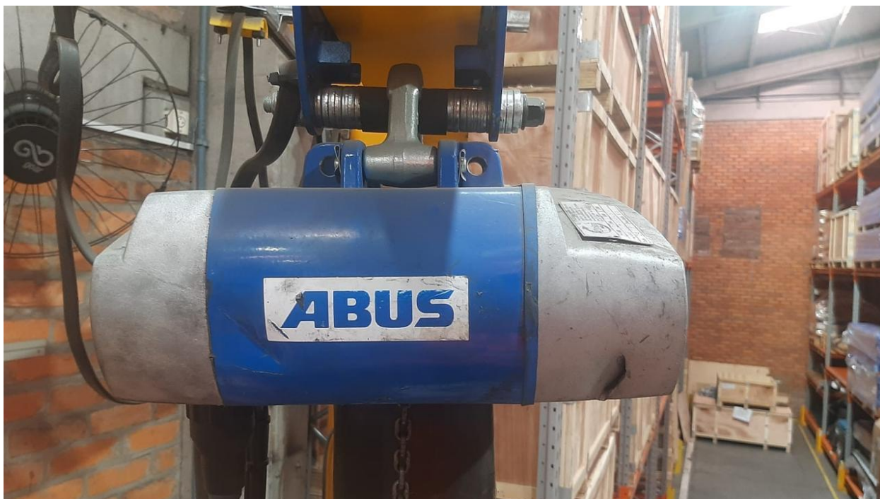
Carcaça do redutor quebrada e carcaça motor danificada.
