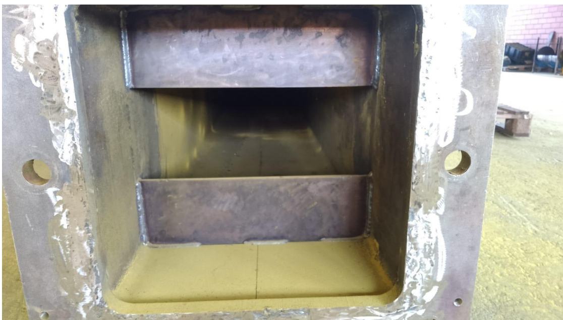
Chapas adicionadas para ganho de rigidez contra fadiga
