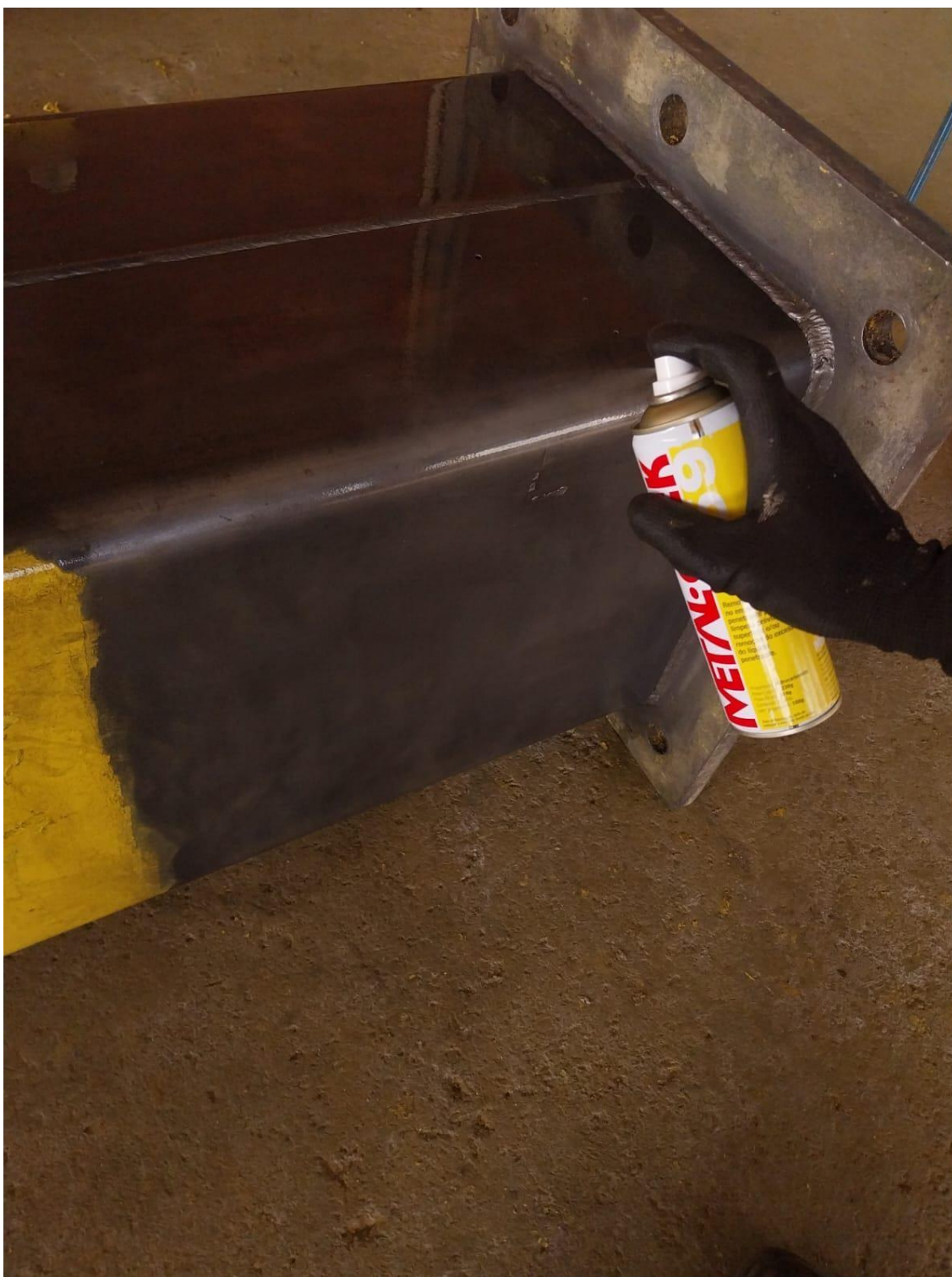
Aplicação do líquido penetrante
