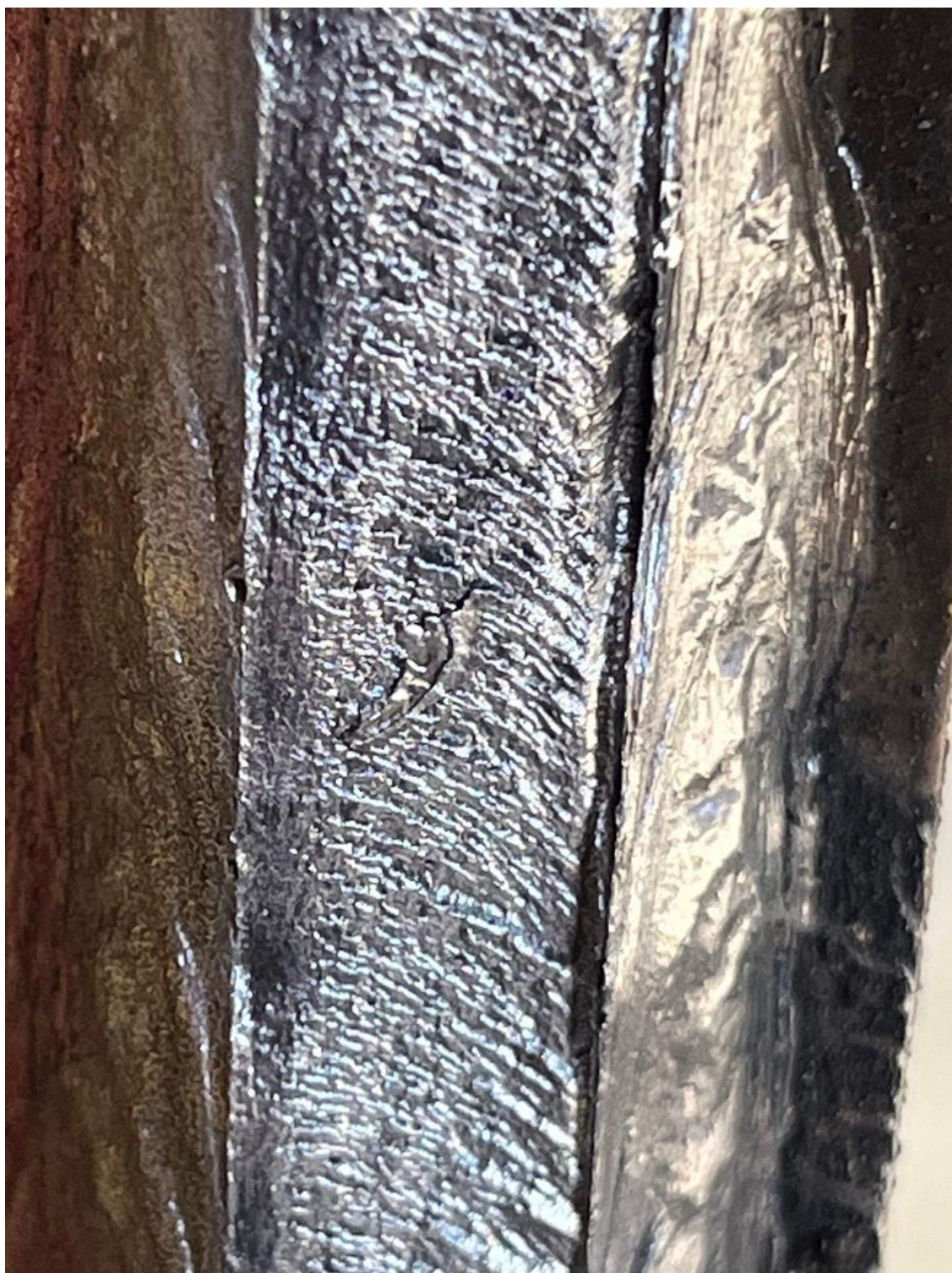
Propagação das fissuras – característica de fadiga
