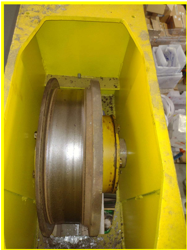
Roda livre de translação – Ponte Rolante 01
