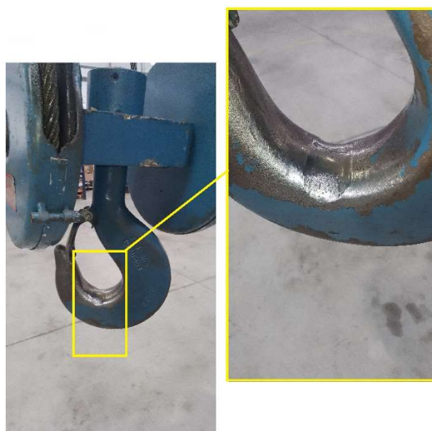
Gancho de levantamento principal apresenta deformação acentuada – Ponte Rolante 01
