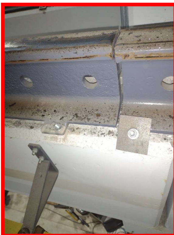
Trilho de rolamento sem tela de junção – Ponte Rolante 02
