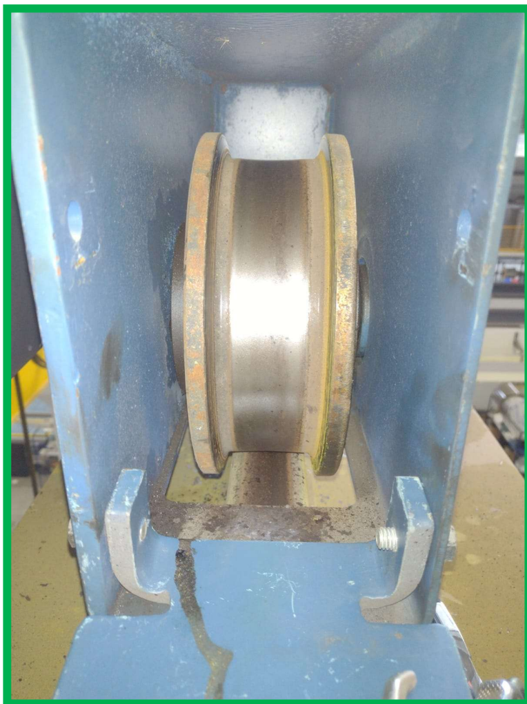
Roda livre de direção – Ponte Rolante 01
