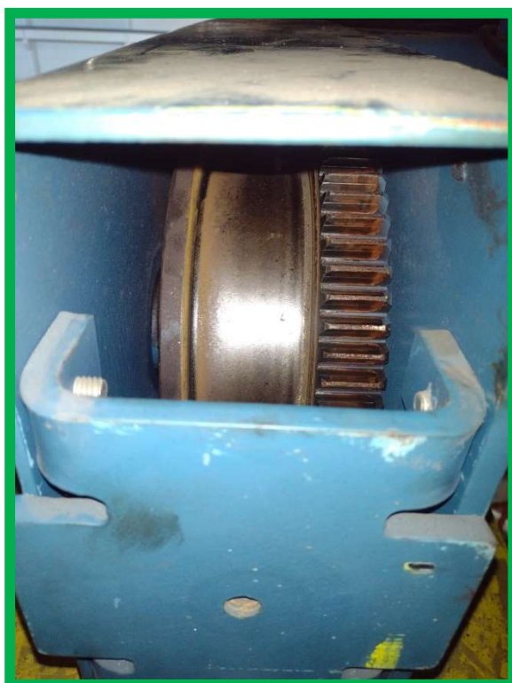
Roda tracionada de direção – Ponte Rolante 02
