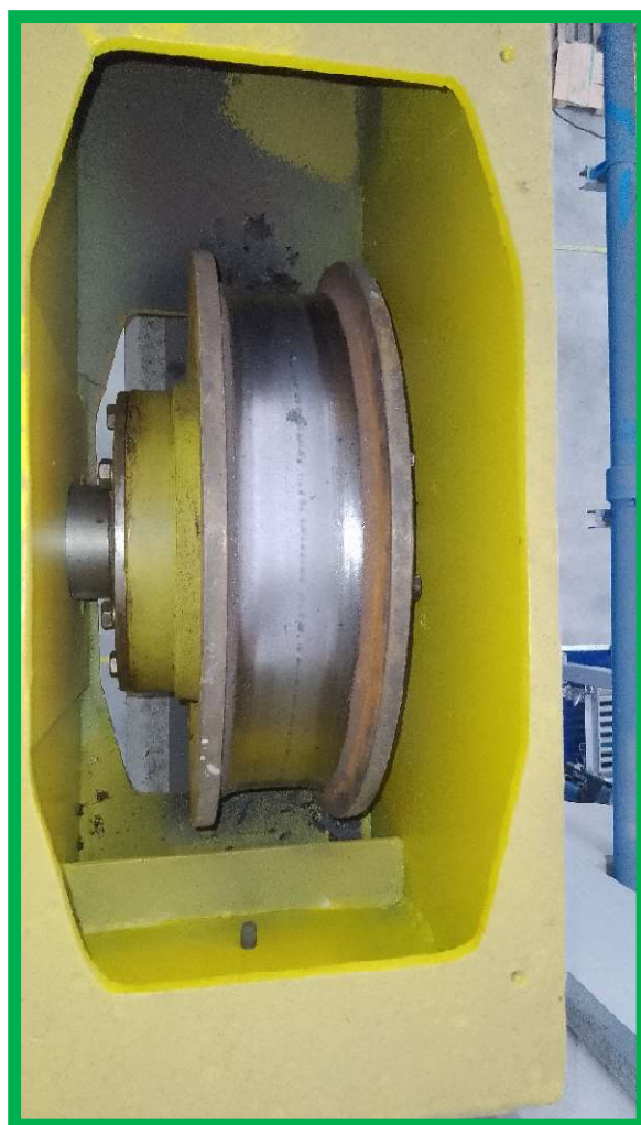
Roda livre de translação – Ponte Rolante 02
