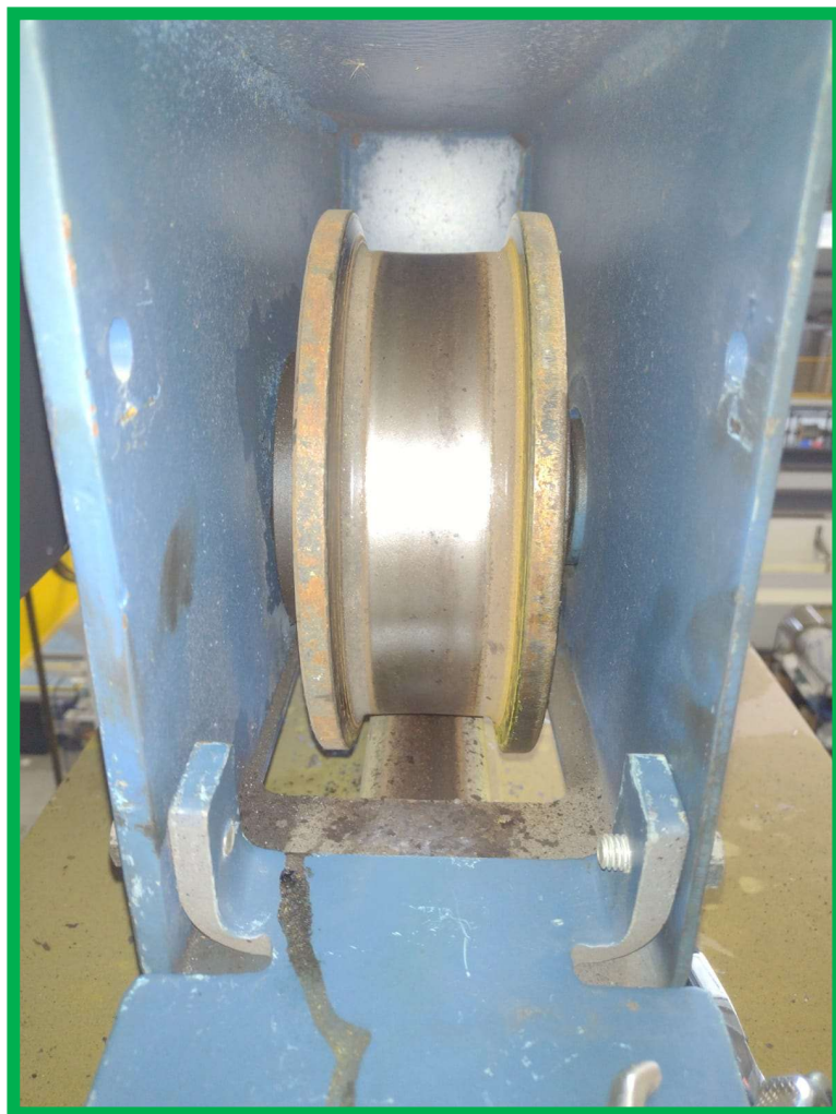
Roda livre de direção – Ponte Rolante 01
