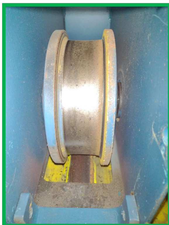
Roda livre de direção – Ponte Rolante 02
