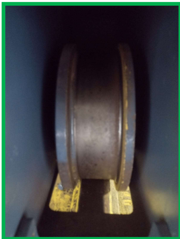
Roda livre de direção – Ponte Rolante 02
