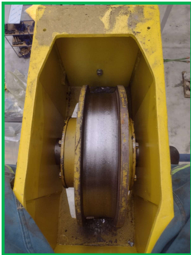
Roda livre de translação – Ponte Rolante 01
