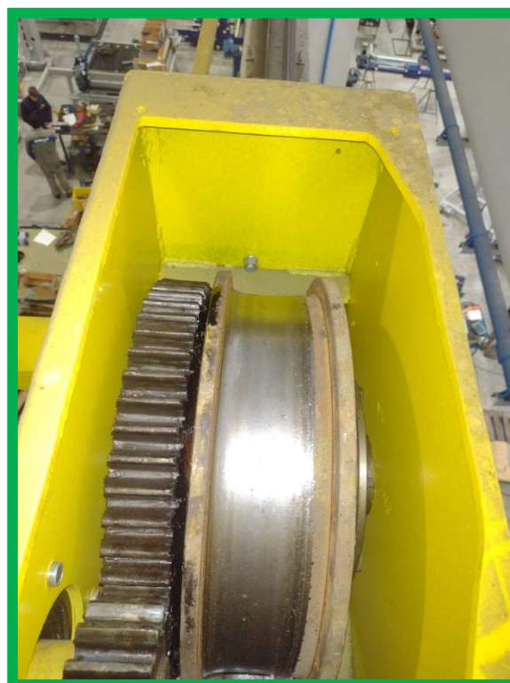
Roda tracionada de translação – Ponte Rolante 02
