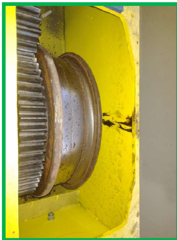
Roda tracionada de translação – Ponte Rolante 02
