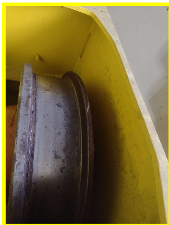
Roda livre de translação – Ponte Rolante 02
