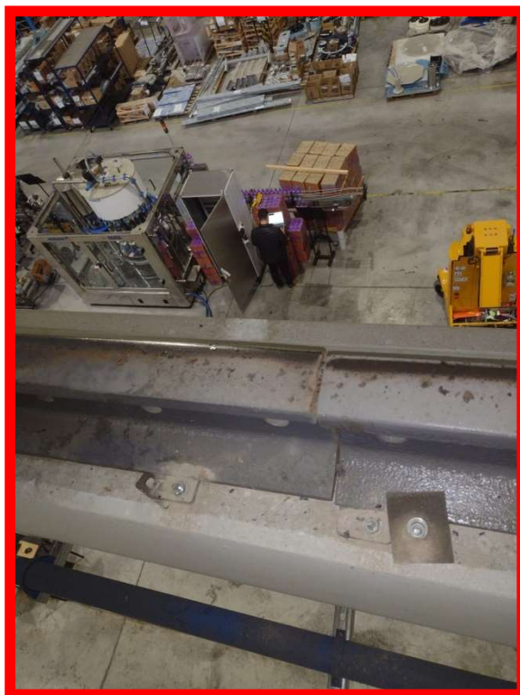
Trilho de rolamento sem tela de junção – Ponte Rolante 01
