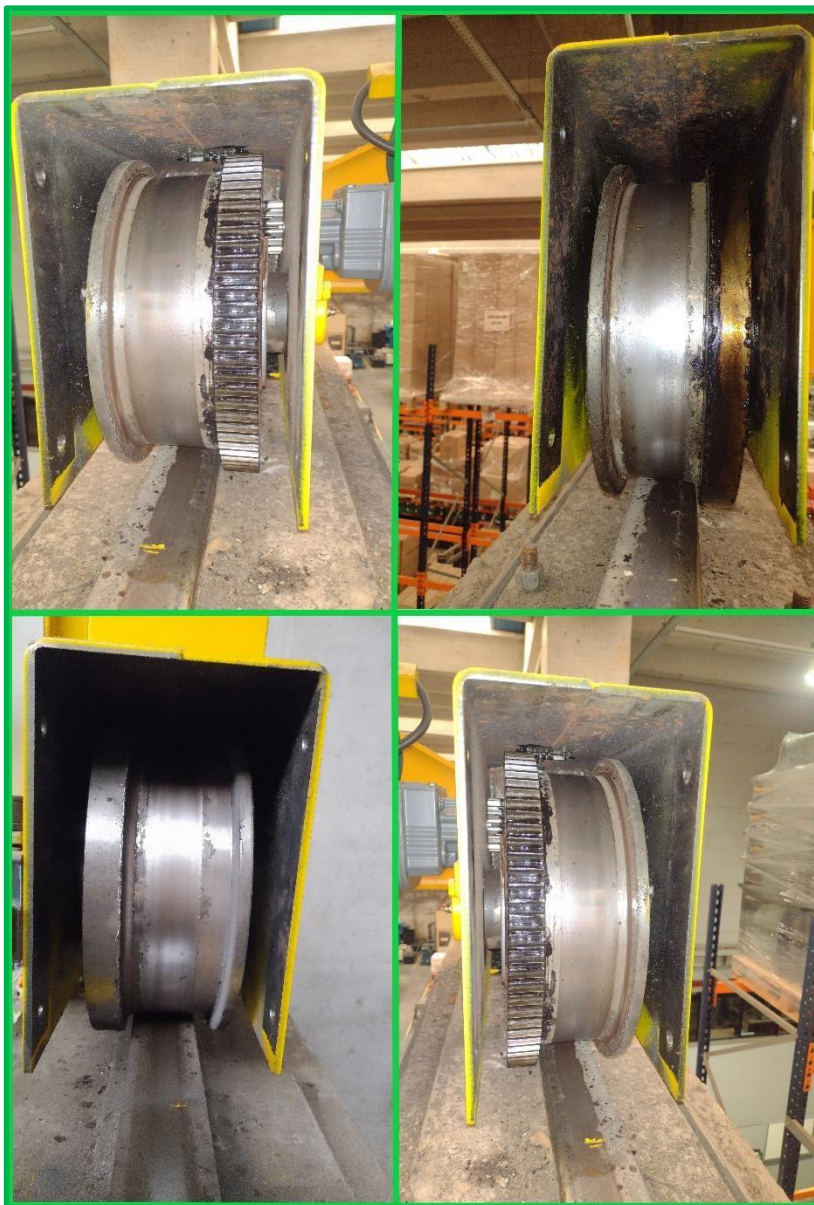
Rodas – Cabeceira - Ponte Rolante 10 TON. Rodas tracionadas – Rodas com engrenamento
