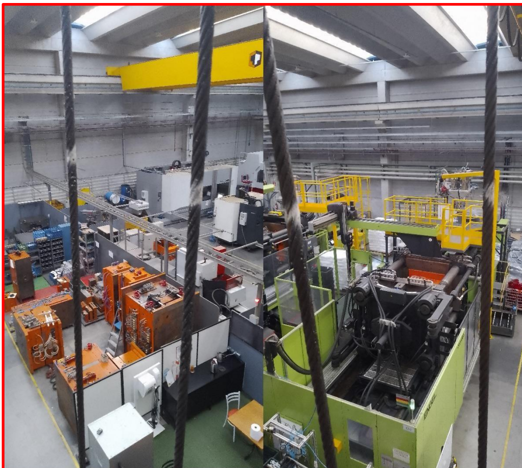
Cabo de aço – Posição 2 (-8,53%) - Ponte Rolante 10 TON.
