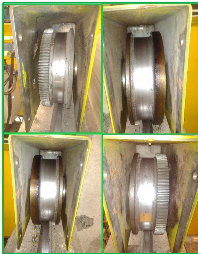
Rodas – Cabeceira - Ponte Rolante 23 TON. Rodas tracionadas – Rodas com engrenamento
