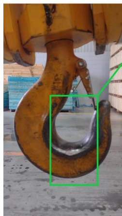
LEVE DEFORMAÇÃO NO GANCHO PRINCIPAL
