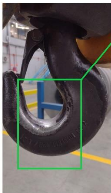
GANCHO EM BOAS CONDIÇÕES
