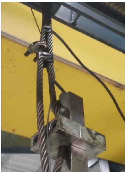
PONTO FIXO MONTADO CORRETAMENTE
