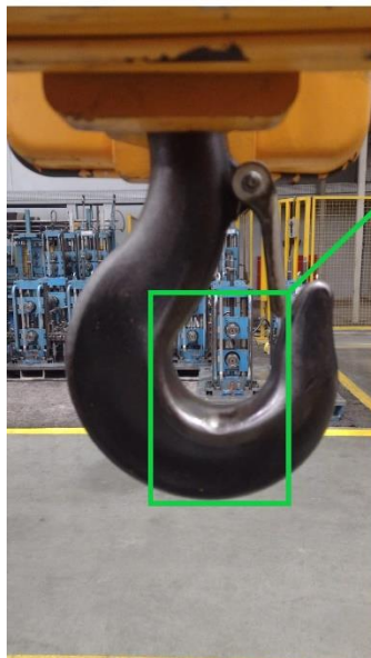
LEVE DEFORMAÇÃO NO GANCHO PRINCIPAL
