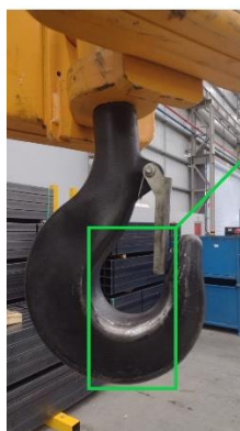
GANCHO EM BOAS CONDIÇÕES
