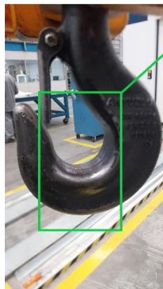
GANCHO EM BOAS CONDIÇÕES
