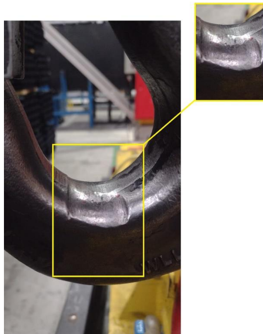
DEFORMAÇÃO ACENTUADA NO GANHO PRINCIPAL
