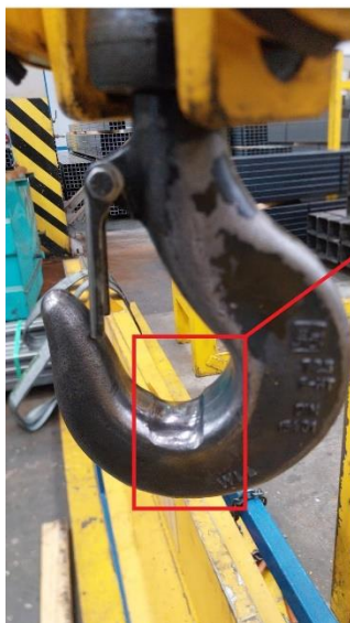
DEFORMAÇÃO CRÍTICA NO GANCHO PRINCIPAL
