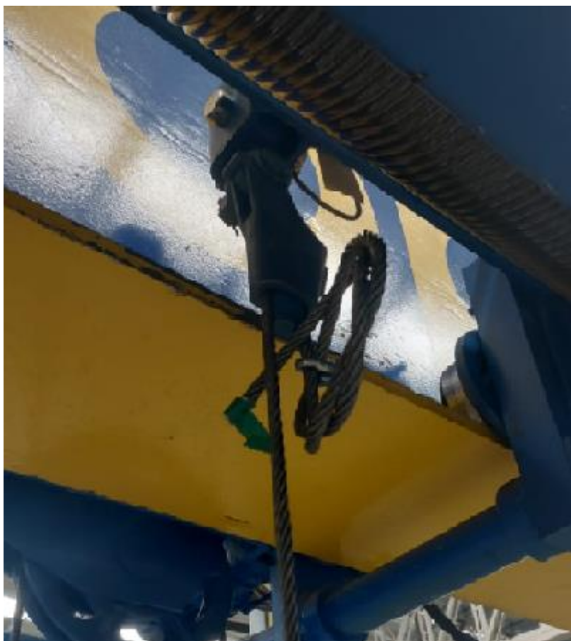
Ondulações Apresentadas no Cabo
