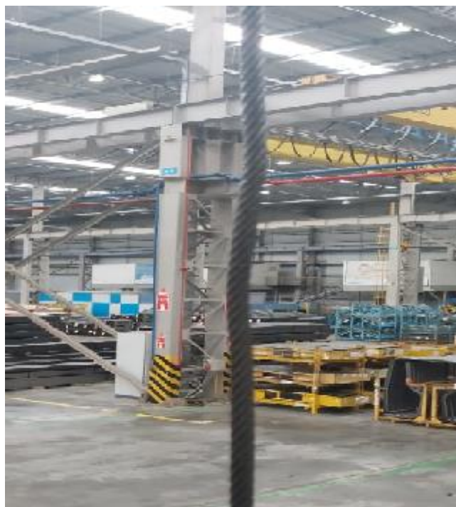
Ondulações Apresentadas no Cabo
